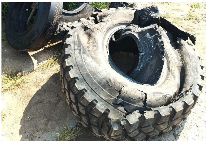
Рисунок 4 – Пошкоджене колесо бронетехніки з VFI Run-Flat вставкою
