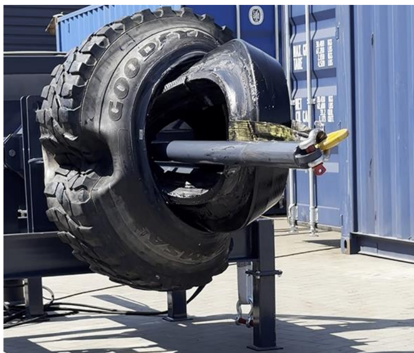
Рисунок 5 – Демонтаж VFI Run-Flat вставки з колеса за допомогою страхувальних тросів та гідравлічних циліндрів пресу
