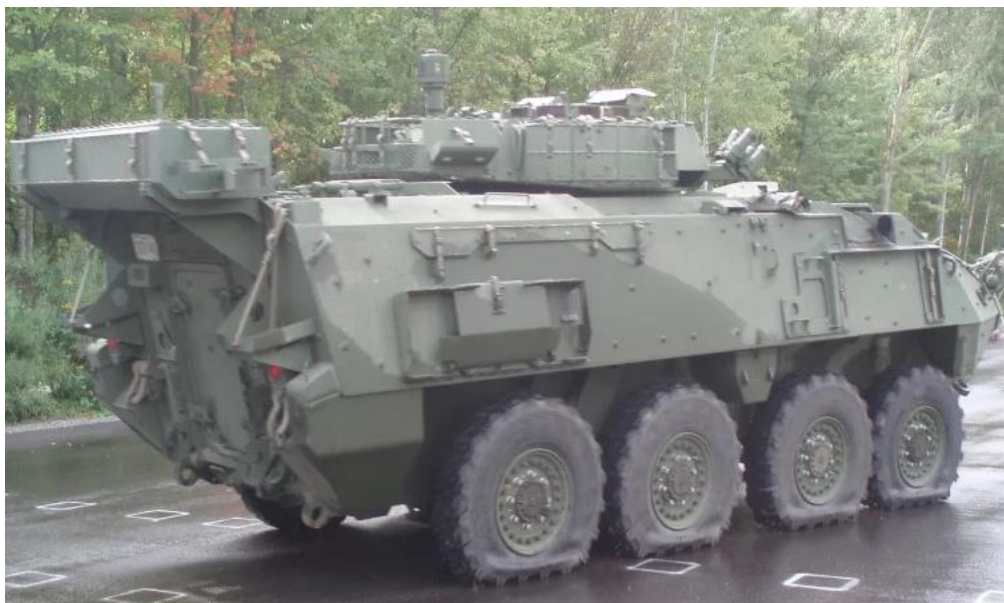
Рисунок 3 – Завдяки VFI Run-Flat вставкам у колесах, техніка залишається на ходу
