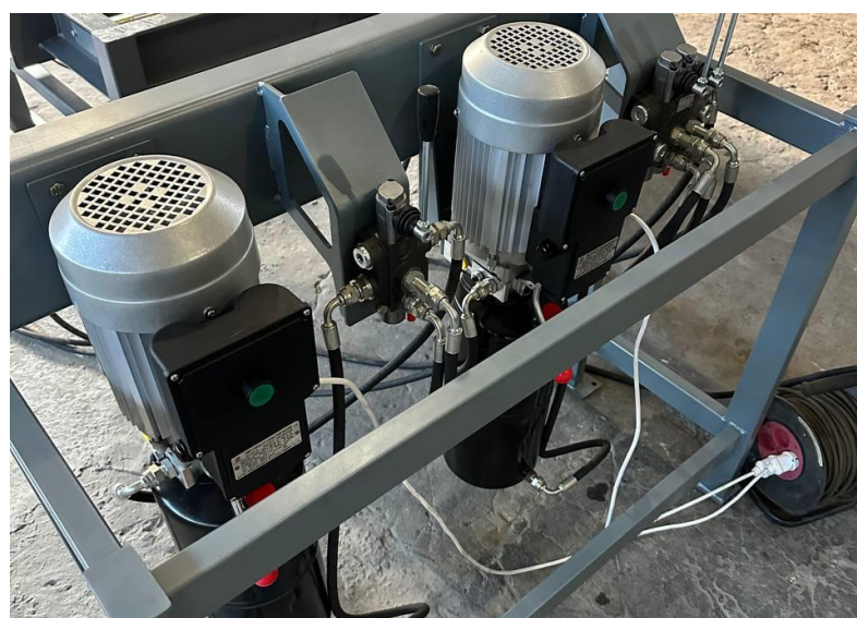
Рисунок 9, 10, 11 – Встановлено більш потужні гідроциліндри, посилено направляючу повзуна та вдосконалено пульт управління
