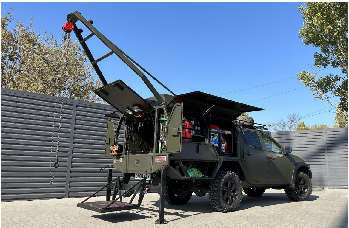
Рисунок 4 – Кран з лебідкою та з'ємний слюсарний верстат
