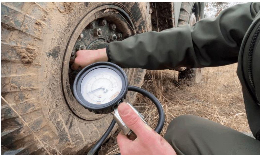
Рисунок 8 – Процес підкачки колеса
