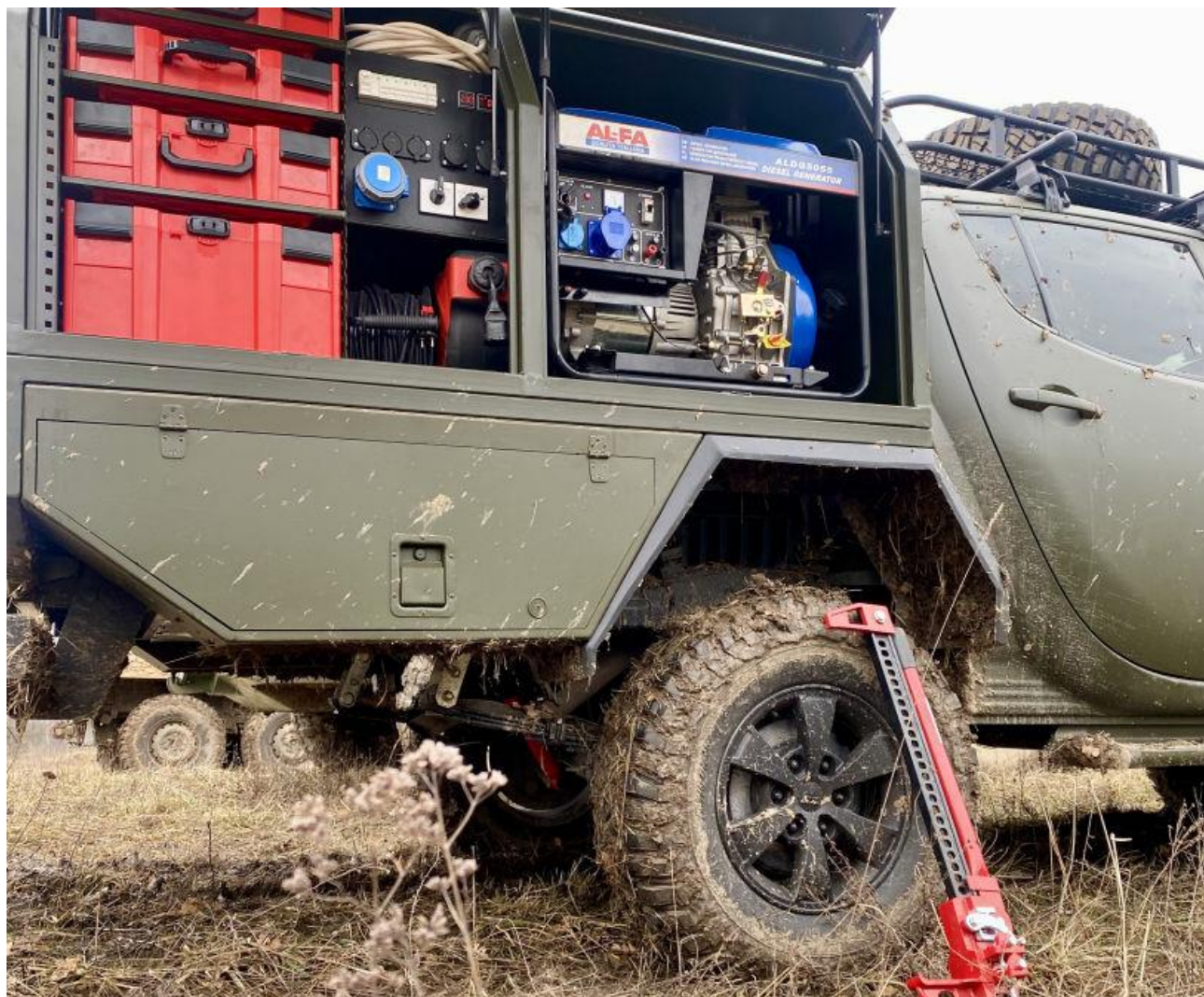
Рисунок 7 – Генератор та електричний щиток управління
