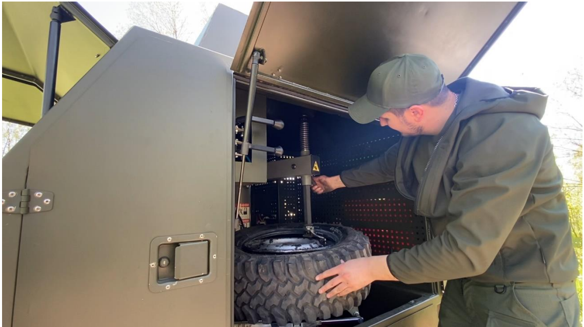
Рисунок 3 – Процес бортування гуми колеса
