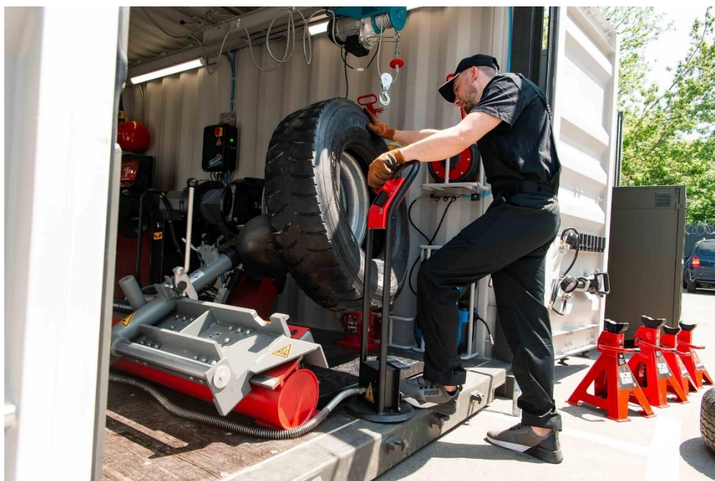
Рисунок 1 – Процес бортування гуми вантажного колеса
