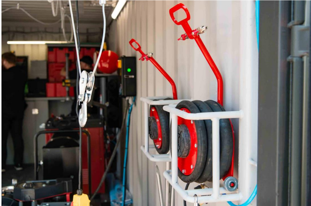
Рисунок 7 – Надійне кріплення пневматичних домкратів на стінці контейнеру
