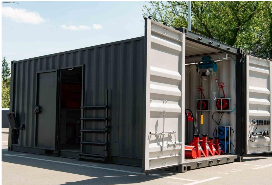
Рисунок 9 – Мобільна майстерня у якості стаціонарного шиномонтажа
