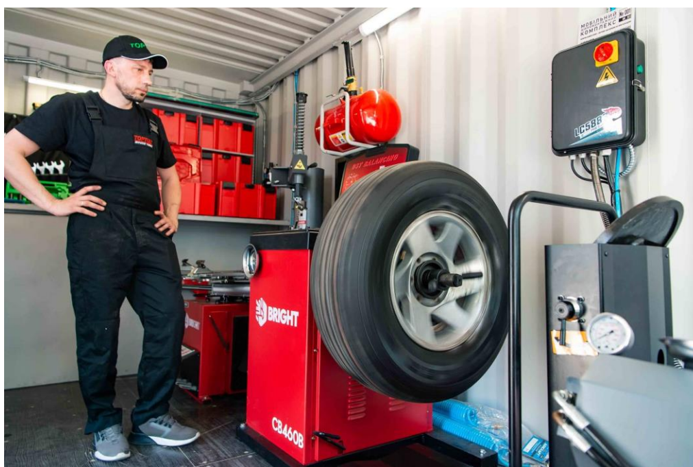
Рисунок 2 – Процес балансування колеса вантажного автомобіля
