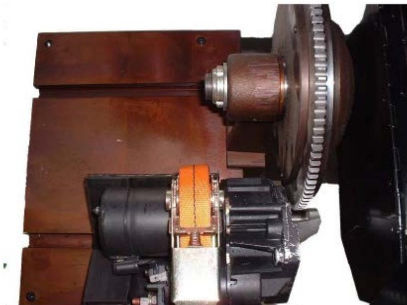
При помощи тормоза вы можете протестировать механическую целостность и поглощение с нагрузкой стартера.
