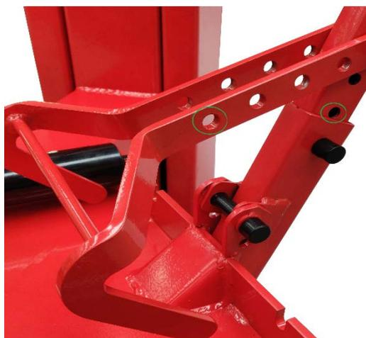
Регулировка под разную ширину шины и высоту боковины шины производится с помощью фиксации рычага разжима в необходимом пазе по вертикали и горизонтали.
