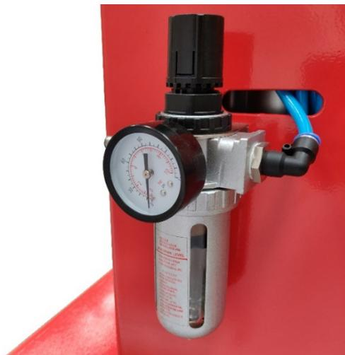
Установлен регулятор давления.
