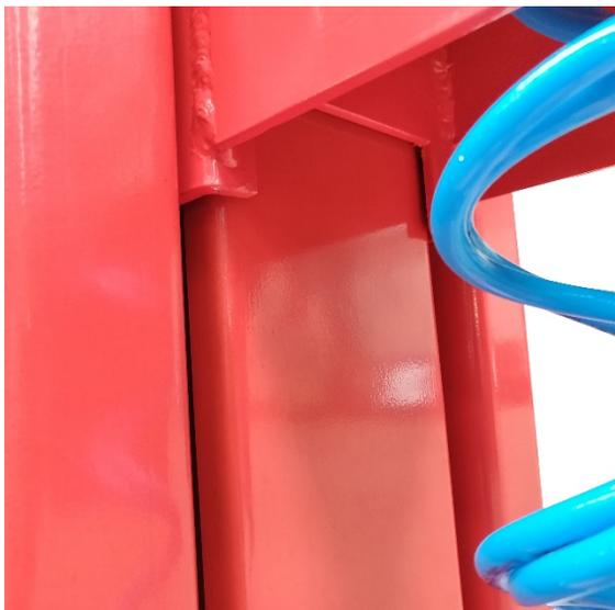
Элементы пневматической магистрали закрыты металлическими кожухами, что предотвращает их зажимание и передавливание и увеличивает долговечность оборудования.
