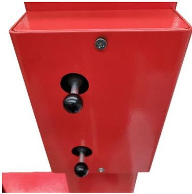
Борторасширитель приводится в действие с помощью двух пневматических цилиндров – разжатия шины и перемещения пневмолифта. Управление работой цилиндров осуществляется простыми и удобными ручными рычагами, которые находятся с боку колонны на комфортной высоте.
