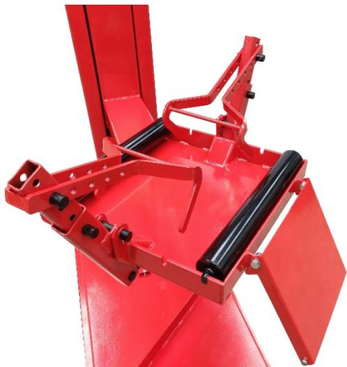
Использование широкого диапазона шин с большим и малым диаметром достигается благодаря несложному процессу увеличения расстояния между опорными роликами, посредством перестановки из одного паза в другой.
