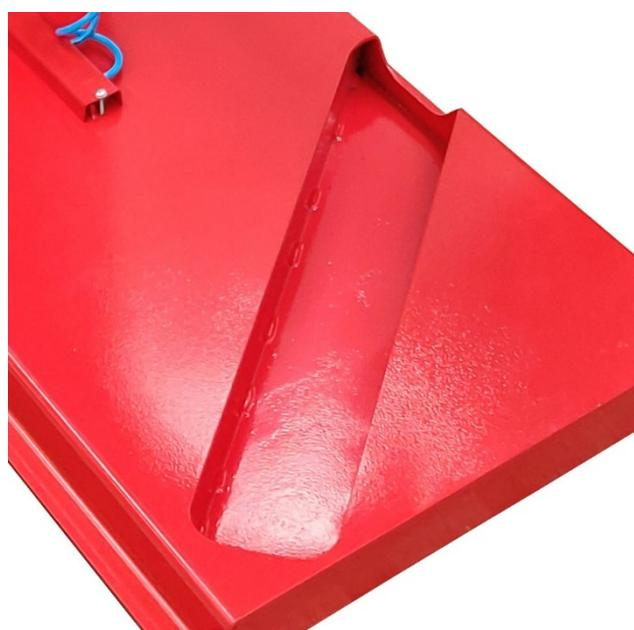
Основание имеет специально сконструированное техническое углубление для пневматического цилиндра расширения шины. Это позволяет опустить рабочую платформу практически до пола, тем самым облегчив установку шин большого диаметра не поднимая их.
