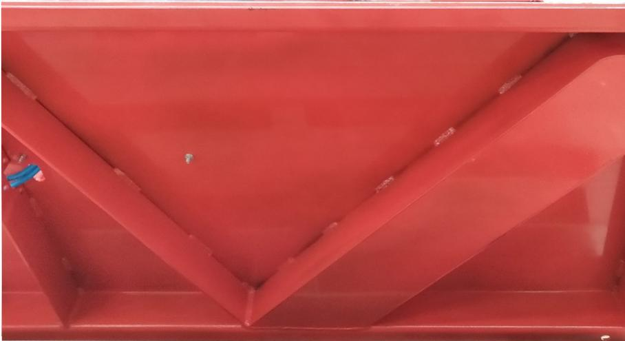
Основание борторасширителя изнутри имеет дополнительные рёбра жёсткости, что увеличивает устойчивость и прочность оборудования.
